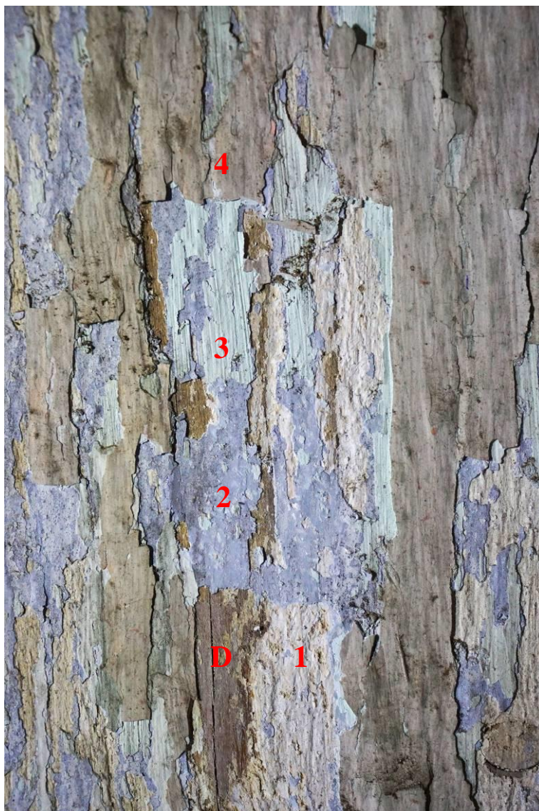
Obr. 16. Sonda č. 3NP/SD1. D: Dřevěná příčka. 1: Vápenný nátěr bílý. 2: Modrá ultramarínová. 3: Světle modrá ultramarínová. 4: Modrá azurová. 5: Vápenná bílá, silně znečištěna a mikrobiologicky poškozena.
